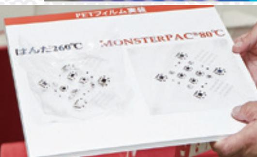
従来の260度の高温と低温実装のモンスターパックの比較。モンスターパックだとPETフィルムの柔軟性を保ったまま基盤を実装できる。
